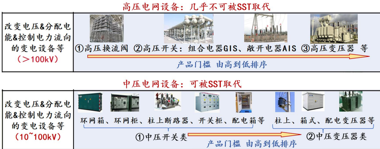
图表：在AIDC场景下，中压电网设备业务可以被SST取代
