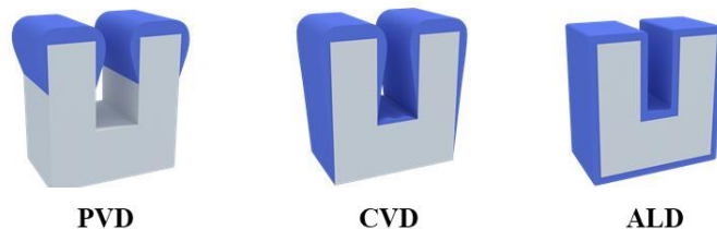
◆ 图：PVD、CVD、ALD薄膜沉积效果示意图，ALD技术成膜效果最好
