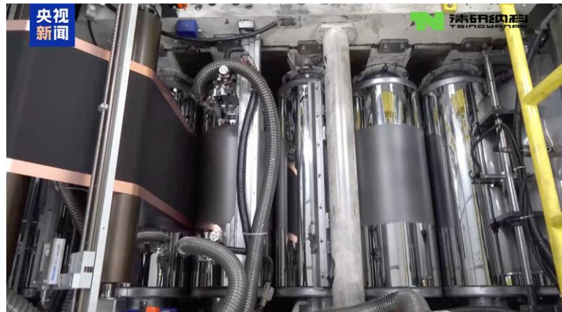
图表30：清研纳科赋能全固态生产线（高速宽幅干法电极设备）
