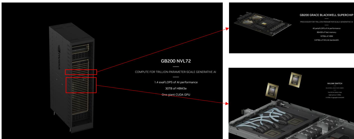
图表28：AI PCB 第二次技术迭代逻辑是 8 卡变为 Rack 架构——改变了 GPU 和 CPU 之间互联的方式
