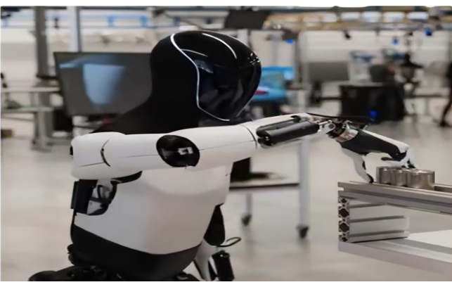
图13：特斯拉 Optimus 机器人在制造工厂分装电池
