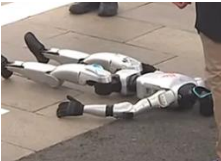
电机性能不稳定会造成机器人摔倒
