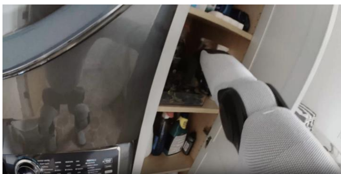
图12: Figure 03 灵巧手采用视触觉方案，即便主视觉被挡住也能完成操作
