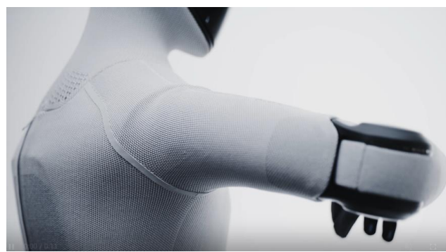
图2: Figure 03 采用软质织物包覆，提升了人机交互的安全性及舒适度
