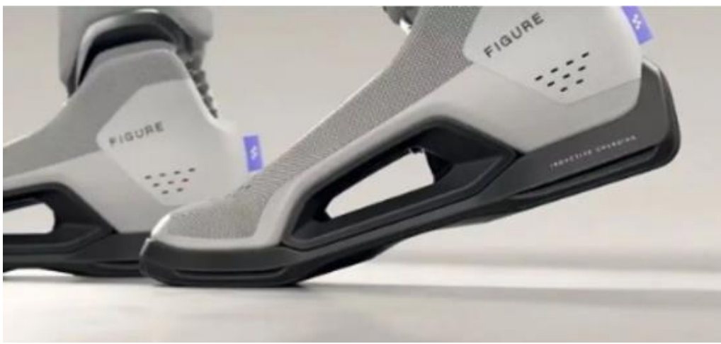
图14: Figure03 支持足底无线充电，无需外部插线接口
