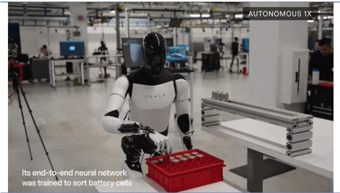
图34：Optimus 在特斯拉汽车工厂进行电池单元分装
