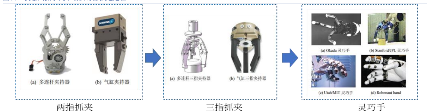
图36：机器人抓手类末端执行器演进过程
