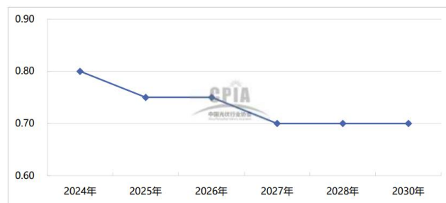
图27: 2024-2030 年三氯氢硅法多晶硅生产线投资成本变化趋势 (单位: 亿元/千吨)
