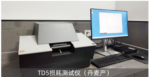
TD5损耗测试仪（丹麦产） TD5 Dielectric Loss Tester (Made in Denmark)
