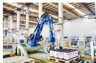
自动包装线 Automatic Packaging Line
