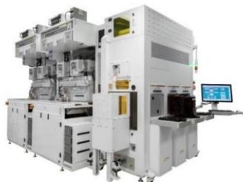
Hydrilis® XT 搭载的干法刻蚀反应腔具有独特的远距电感耦合等离子体 (ICP) 源功率来提供高浓度等离子体。专有的法拉第屏蔽 ICP 源功率与偏置功率相结合, 提供了双重控制能力, 改进了低温下的晶圆上工艺控制。Hydrilis® 生产平台具有两个真空传输模块, 可以承载 4 个双晶圆反应腔来提供卓越的生产效率, 并且能提供灵活的腔体配置来实现多步集成工艺流程。
