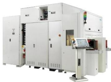
Millios®闪光毫秒级退火设备基于拥有自主知识产权的氩气水壁电弧灯设计，匹配精确的晶圆顶层及背部温度瞬时量测与控制系统，同时具有独特的交错点灯能力。设备可以依据客户制程工艺需求调整毫秒级退火升温曲线并有效控制晶圆热应力，达到良好的器件电性指标，同时有效避免晶圆破片。
