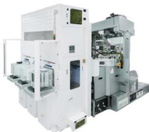
paradigmE®系列刻蚀设备采取双晶圆反应腔、双反应腔产品平台设计。真空晶圆传送系统采取独特的四机械手设计，可以实现反应腔和传输腔之间的超快速晶圆置换，实现高设备生产效率。接地法拉第屏蔽电感耦合等离子体技术获得 10 余项全球专利保护，可以独立调整离子能量和离子密度，覆盖传统电感耦合等离子体 ICP 和电容耦合等离子体 CCP 刻蚀工艺的离子能量范围，同时有效避免因等离子体引发的器件损伤，提高刻蚀制程中不同材料的选择比，扩大产品工艺应用领域。独特的等离子体发生器设计可以进一步有效减小等离子体刻蚀对反应腔壁的损伤，降低机台损耗品成本和综合持有成本。
