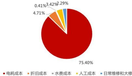
资料来源：华源证券研究所测算。注：假设电解槽成本 1200 元/kW，电价为 0.3 元/kWh，年利用小时数 5000h、单位电耗 4.9kWh/Nm<sup>3</sup>
