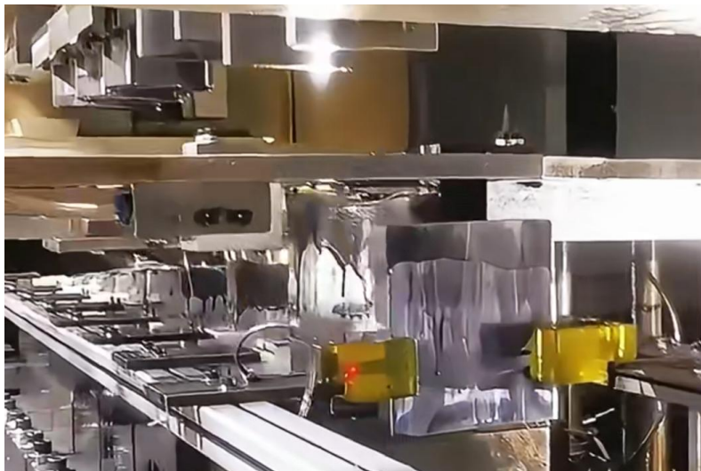
◆图：大部分液态电池采用一体化冲压铝壳，仅需焊接顶盖
