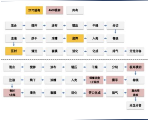
图表6：21700电池与46800电池生产工艺对比
