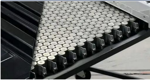
图表7：特斯拉大圆柱电池CTC设计
