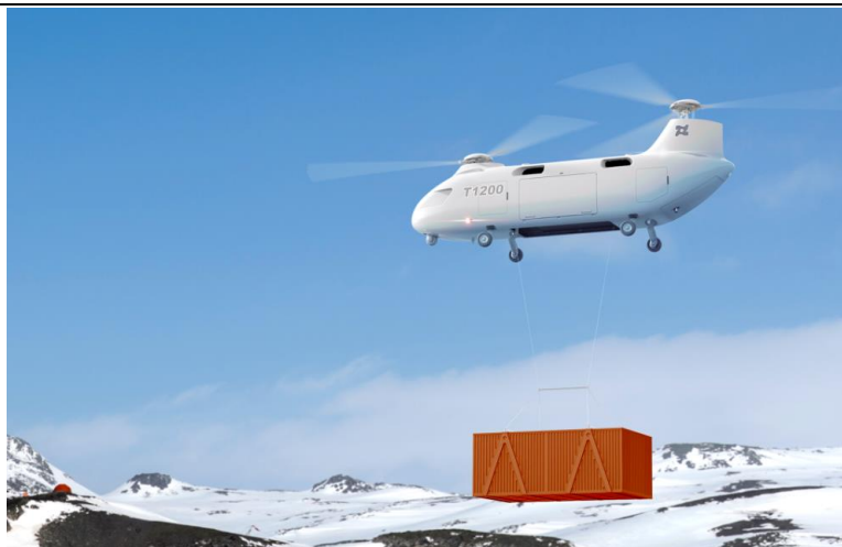
图10：联合飞机自主研发的全球首款 6 吨级倾转旋翼飞行器商载 2 吨，航程 4000km
