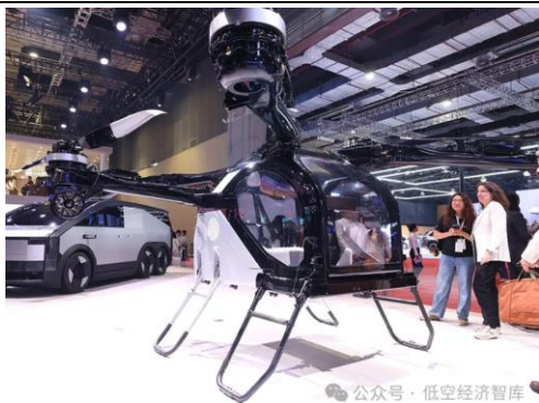
图8：小鹏汇天飞行汽车采用分体式结构
