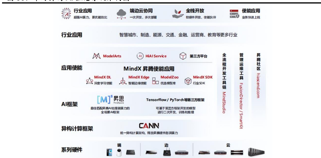
图 36：华为昇腾 AI 生态系统架构图
