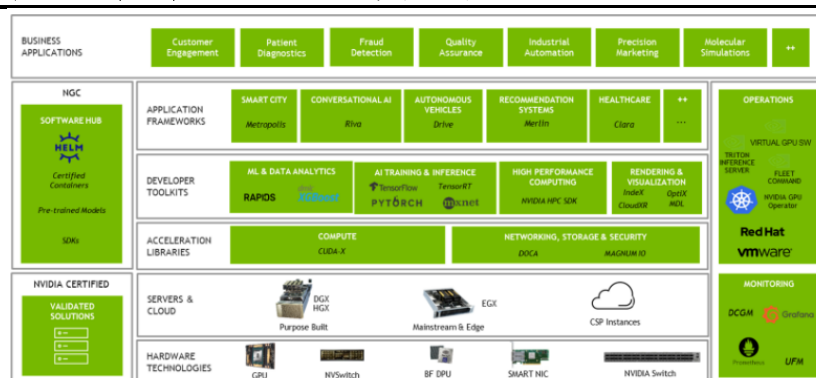
图 31：英伟达数据中心平台 GPU 生态体系架构图
