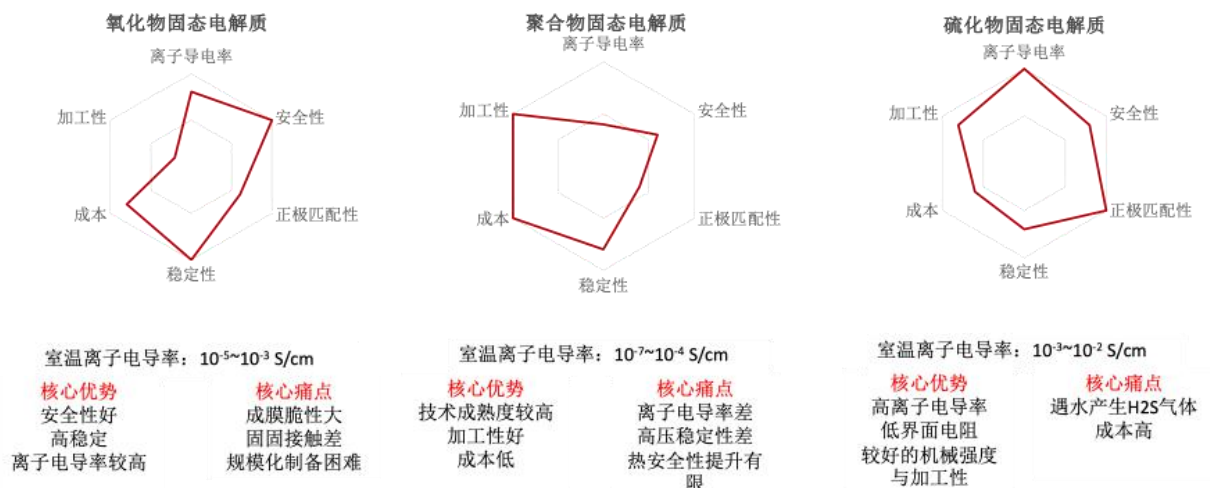
图 7：不同固态电解质对比
