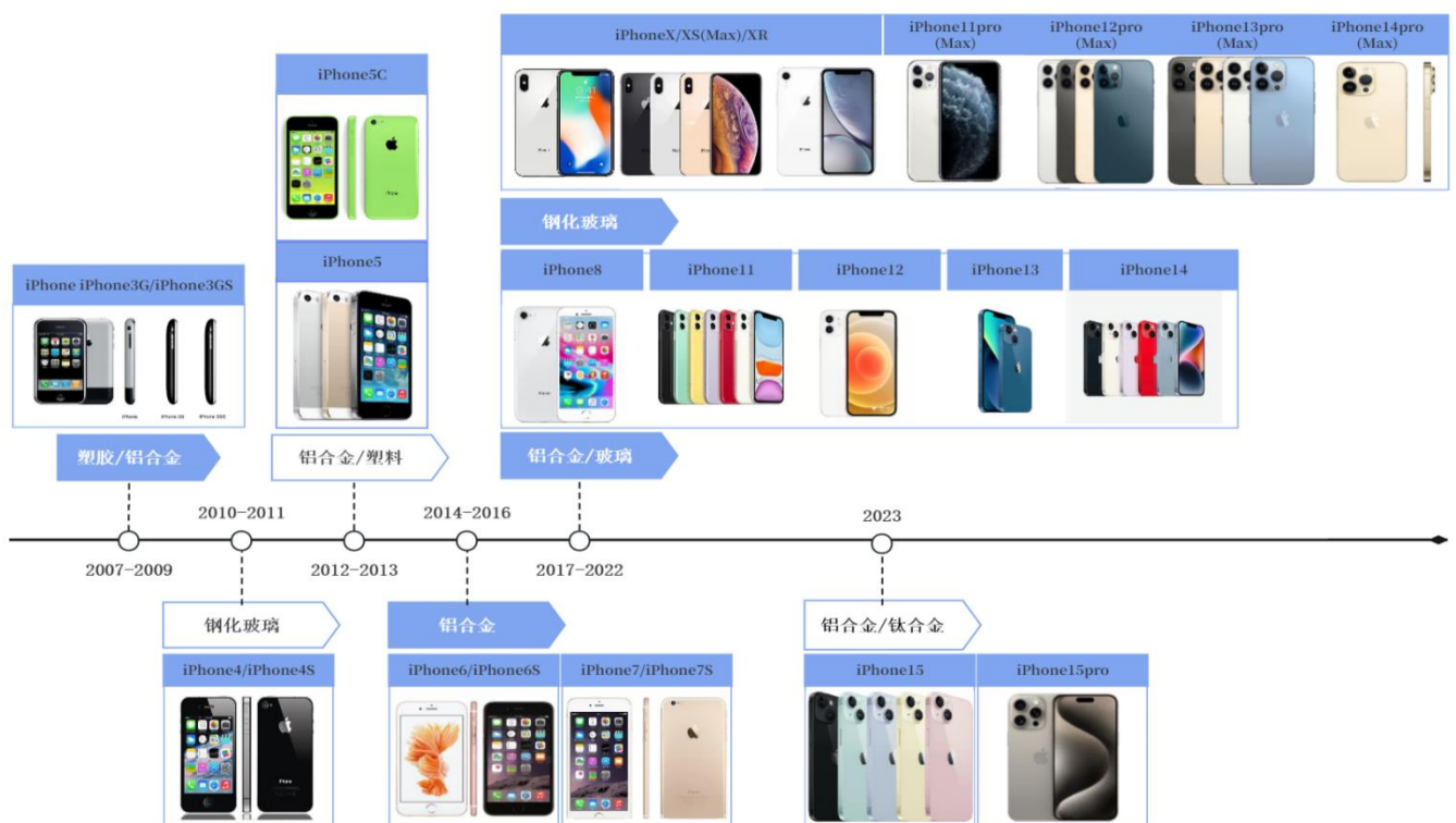
图表 5：苹果手机中框材料变化
