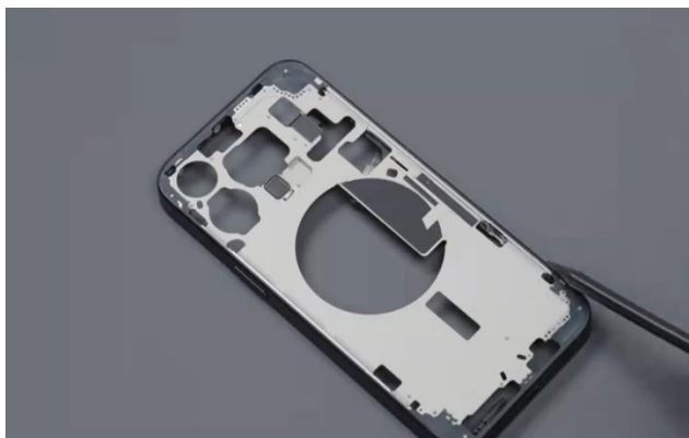
图表 6: Iphone 15 pro 中框拆解图示
