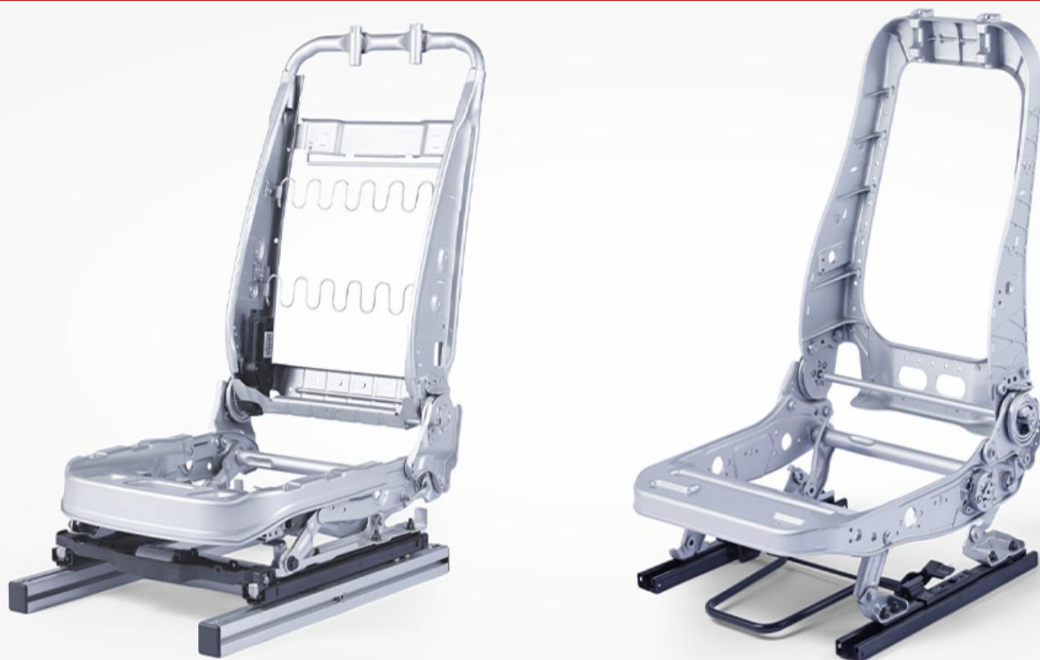
图表 65：天成自控的座椅骨架兼顾安全性与轻量化
