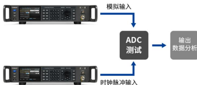
图19：鼎阳 SSG6000A 系列微波信号发生器达 40GHz
