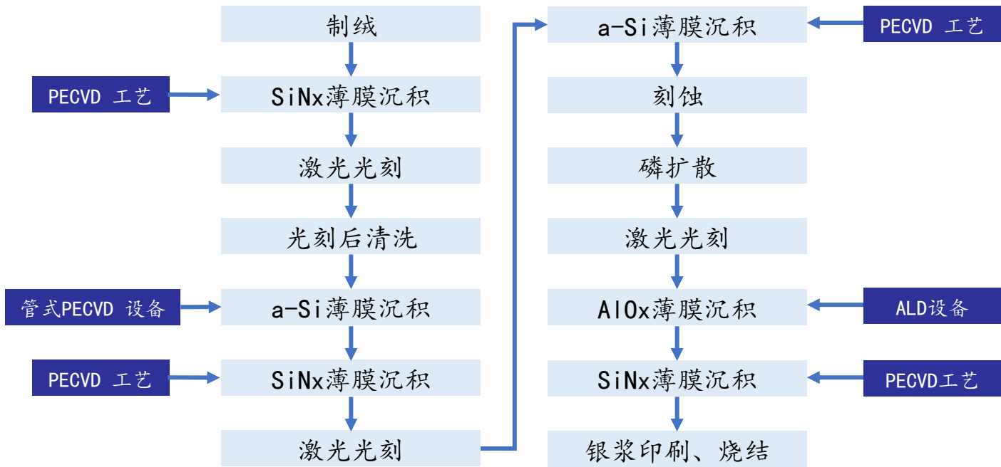
图：爱旭股份ABC电池片工艺流程图（部分涉密流程公司未予展示）
