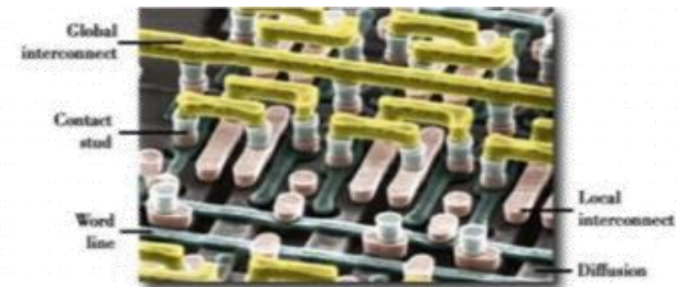
图：集成电路结构可达数百层
