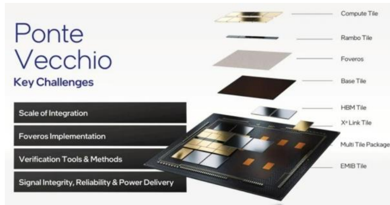
图 15：英特尔超算芯片 Ponte Vecchio 结构
