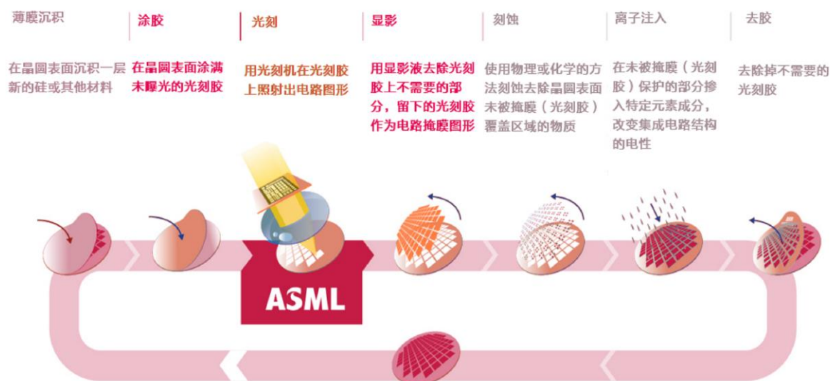
图4.芯片生产的工艺步骤
