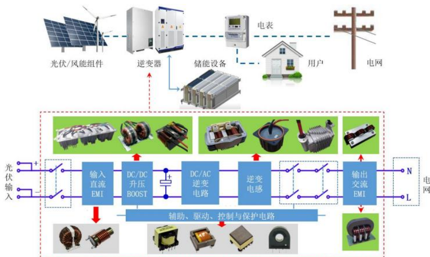
图 1：光伏储能系统中磁性原件的应用
