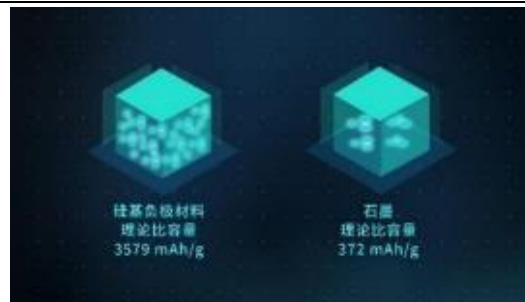
图表 47: 石墨和硅基负极材料的理论比容量
