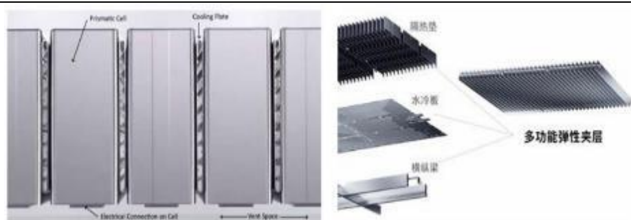
图表 48: 麒麟电池 CTP3.0 电池水冷板设计示意图
