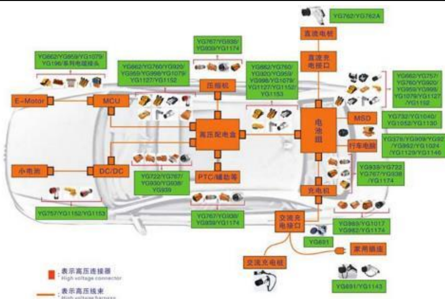
图表 54: 高压连接器在新能源汽车的应用
