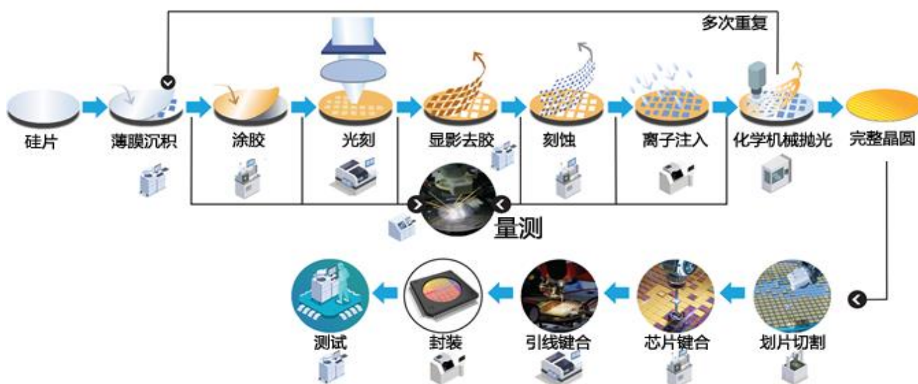
图3.量测在整个芯片生产流程中的位置
