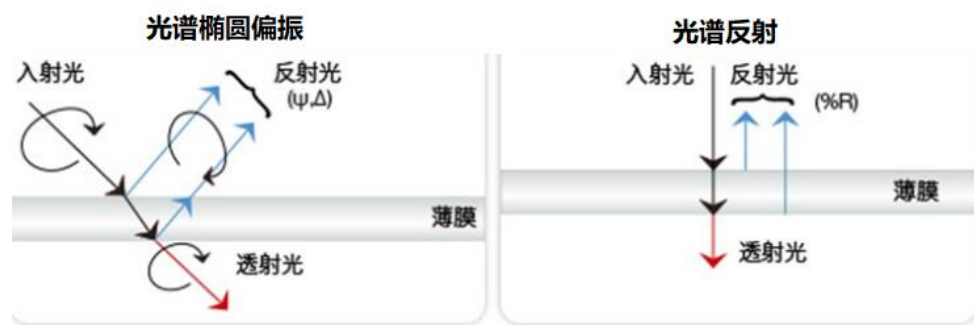
图10.两种光学膜厚测量方法
