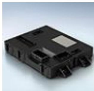
图2：典型 ECU 模块，由 PCB 板，接插件以及保护外壳组成
