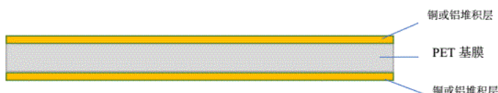
图表 3：复合集流体（复合铝箔/复合铜箔）的结构示意图
