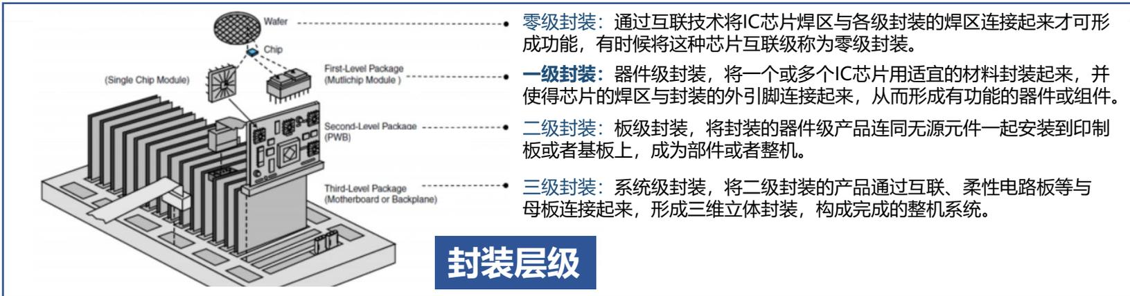
封装的不同层级实际代表着互连密度的不同。2.5D/3D封装属于一级封装，对应IC载板的线宽线距通常在15微米以下。IC载板把芯片特征尺寸放大到与基板特征尺寸对应的I/O输出，实现芯片和基板的互连。常用的IC载板包括ABF载板和BT载板。
