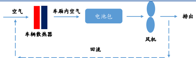
图表 31：主动式风冷（强制冷却）热管理路线
