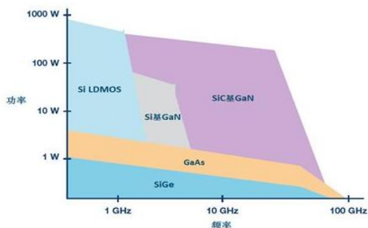
图 13：不同材料微波射频器件的应用范围对比
