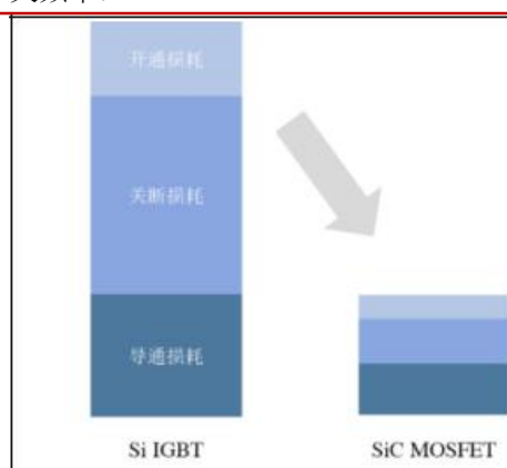
图 18：硅基 IGBT 与 SiCMOSFET 对比（40kHz 开关频率）
