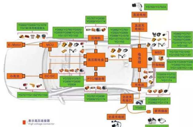
图 3：高压连接器在新能源汽车中的应用
