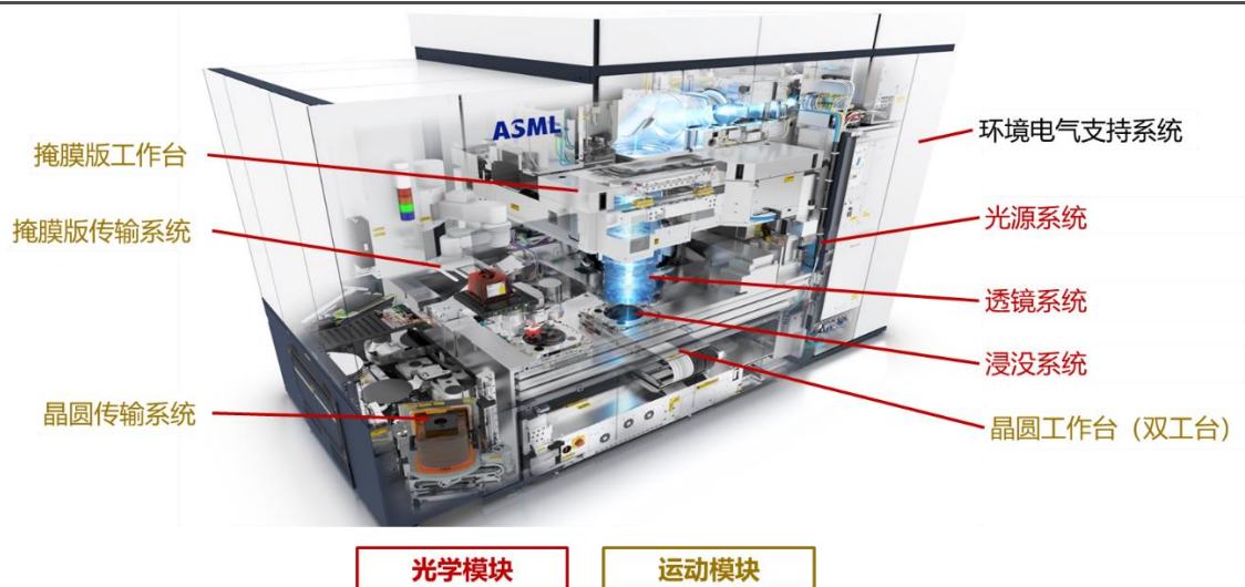
图3：光刻机核心系统示意图
