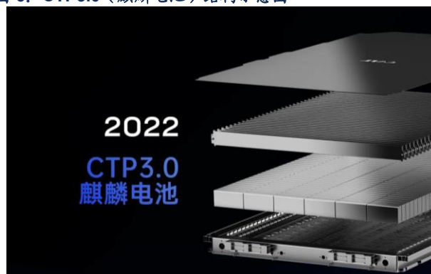
图 6：CTP3.0 (麒麟电池) 结构示意图
