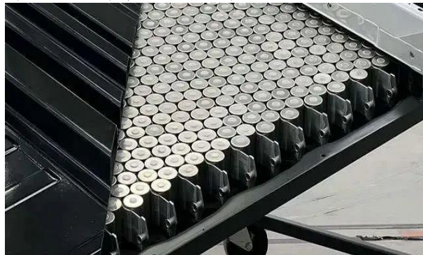
图 18：CTC 冷却与热隔离结构
