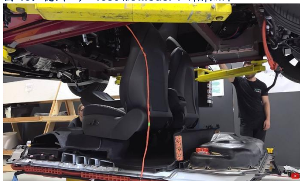
图 19：德州工厂 4680 版 Model Y 拆解照片
