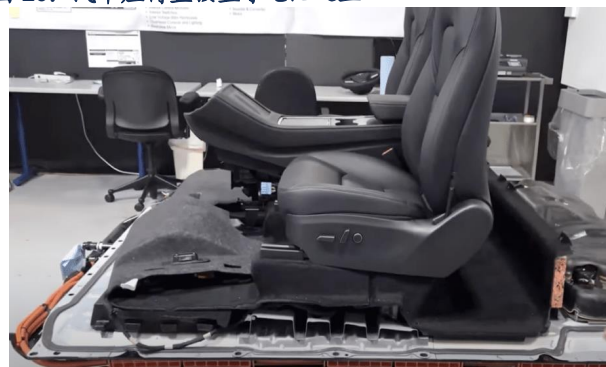
图 20：汽车座椅直接置于电池之上
