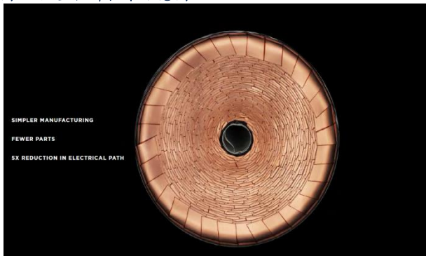
图 14：全极耳技术示意图
