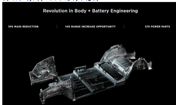
图 17：特斯拉 CTC 结构示意图
