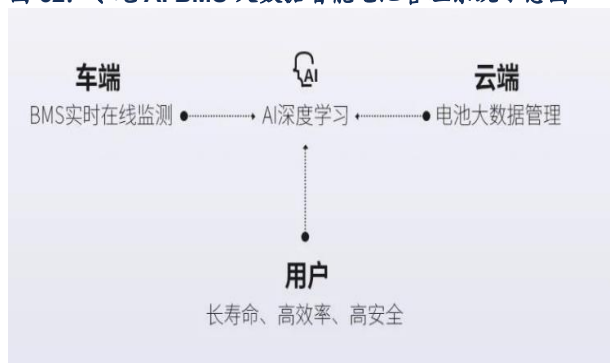
图 52: 零跑 AI BMS 大数据智能电池管理系统示意图
