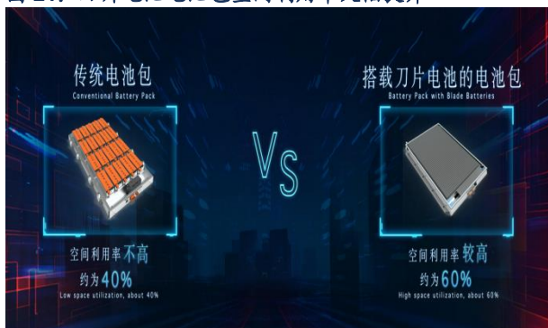
图 21：刀片电池电池包空间利用率大幅提升
