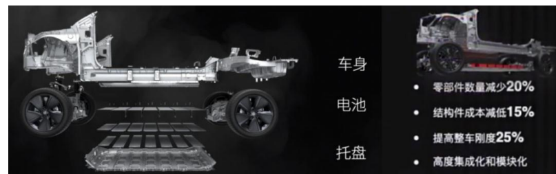
图：零跑MTC电池
