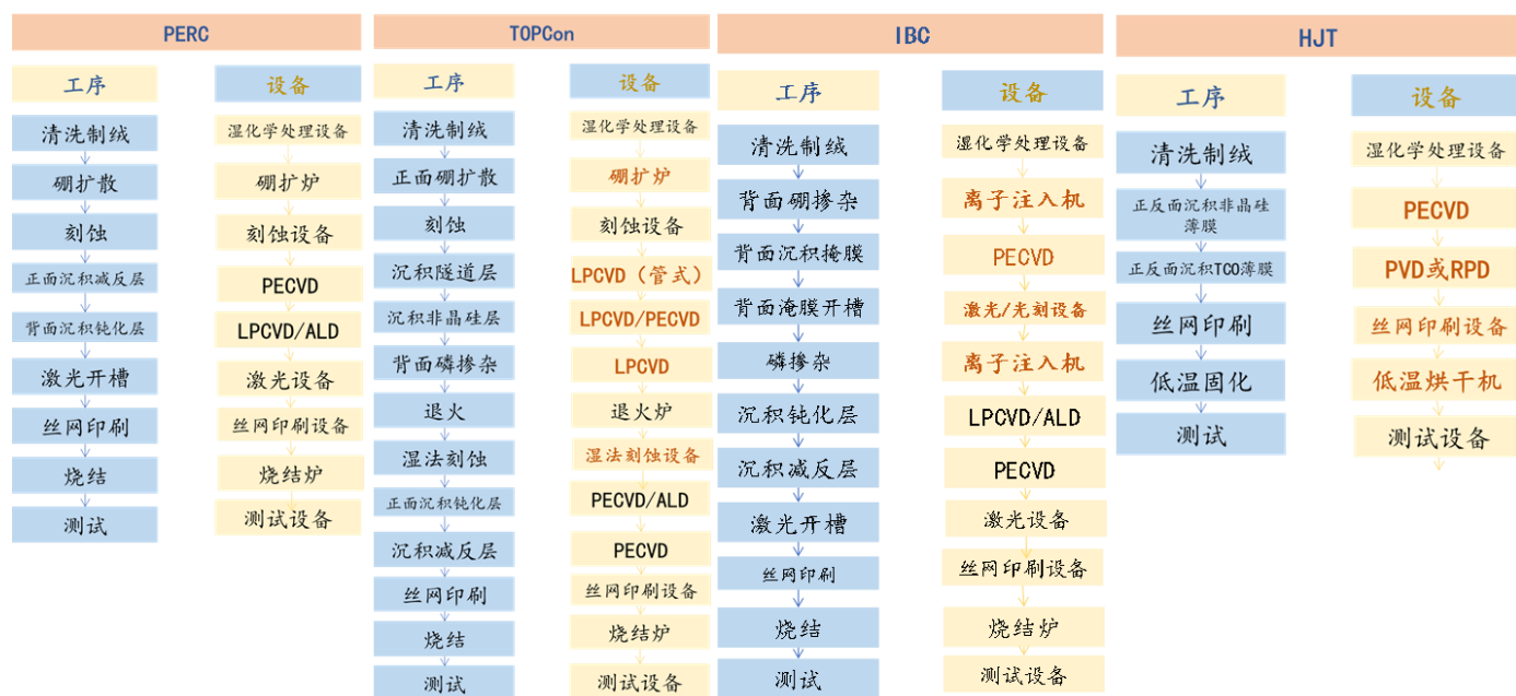
图 3：TOPCon 工艺与产线与 PERC 兼容性较强，HJT 与 PERC 工艺与产线不兼容
