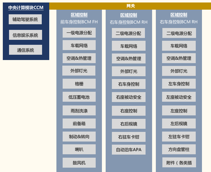
图表 29：特斯拉 Model 3 域控网络结构
