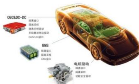
图 9：数字隔离芯片在汽车中的应用
