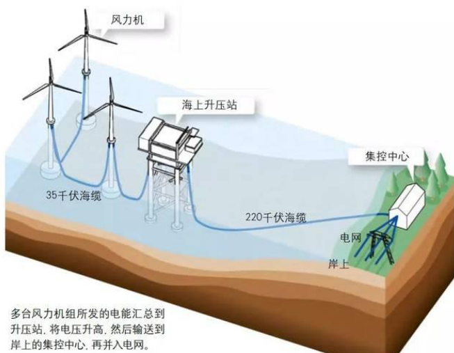
图 52: 海缆是海上风电项目三大基础件之一
