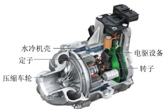
图表 20：德国 Audi SQ7 车用驱动电机系统冷却结构
