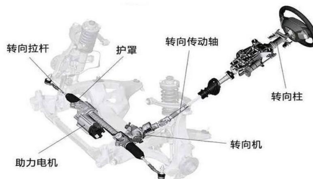
图 21: 电动助力转向系统结构图 (EPS)
