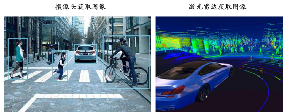
图 63：摄像头视觉派 VS 激光雷达派路获取数据图
