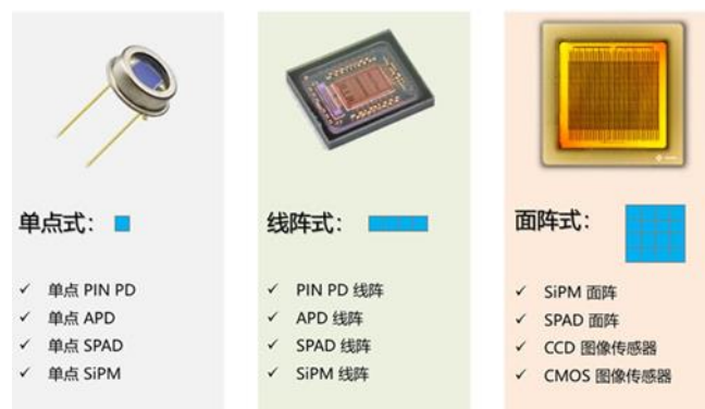
图 94：探测器发展方向：由点到面
