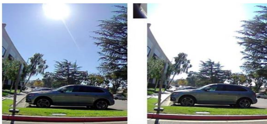
图 76：车载 CIS HDR 成像效果对比
