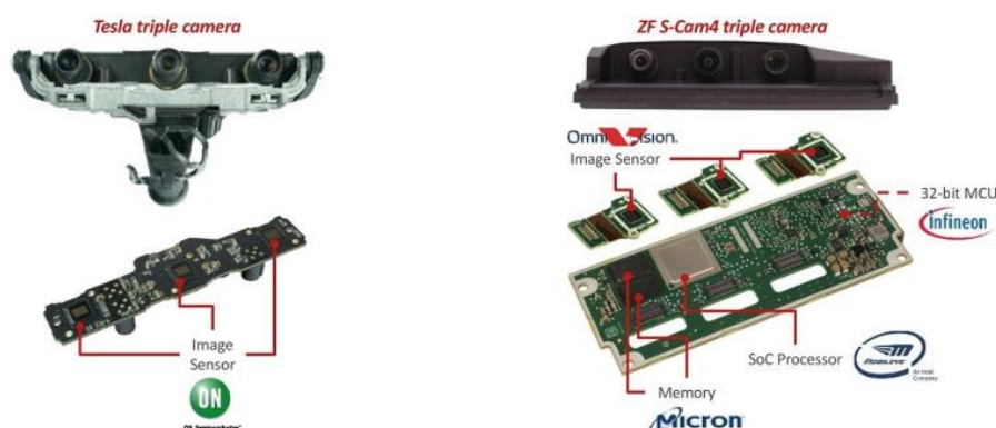
图 72：特斯拉三目前视摄像头与采孚三目前视摄像头的对比
