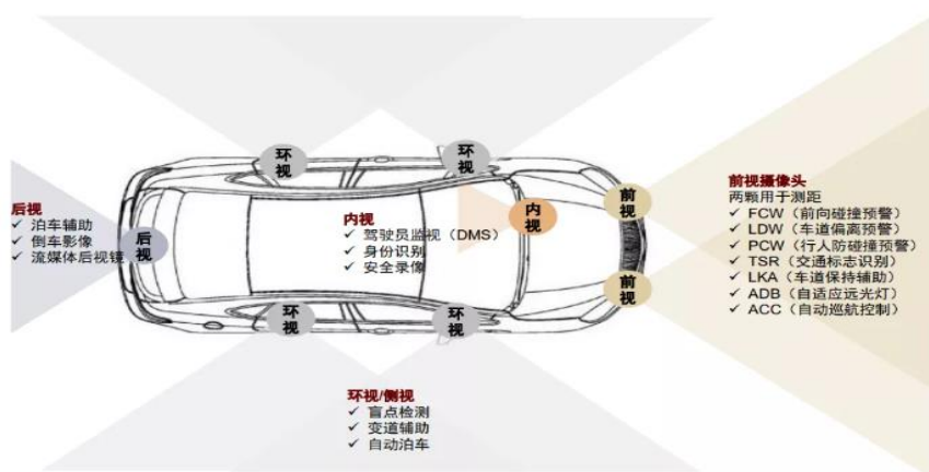
图 71:汽车搭载摄像头分布
