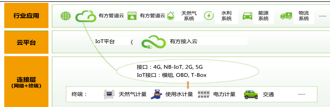
图 36：有方科技云-管-端一体化接入通信方案
