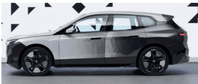
图表 5: 宝马“电子墨水”技术下车身变色示意图
