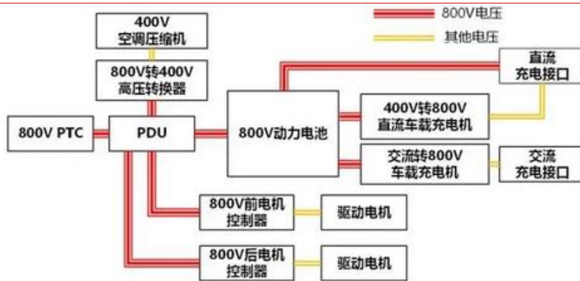
图表 1：保时捷 Taycan 高压架构
