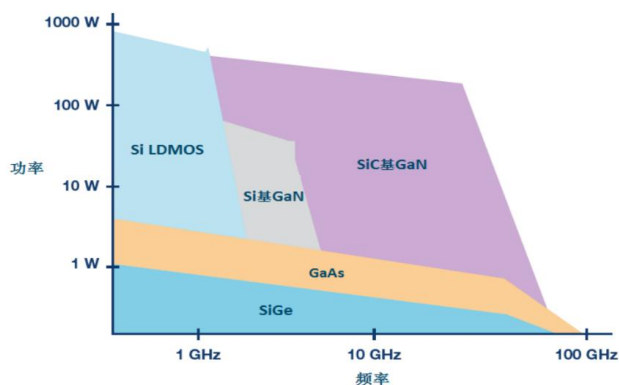
图 13: 不同材料微波射频器件的应用范围对比
