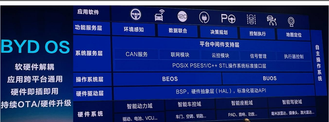
图表10 e3.0 搭载软硬件解耦的车用操作系统 BYD OS
