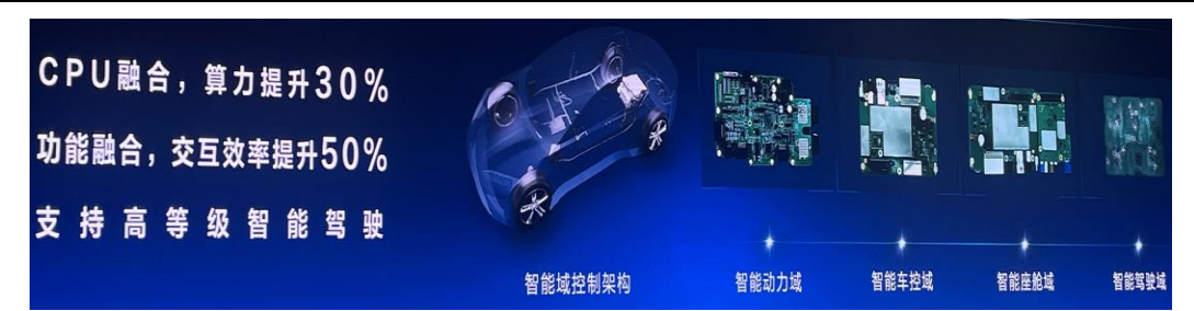
图表9 e3.0 将传统分布式电子电气架构整合成为四大域控制器
