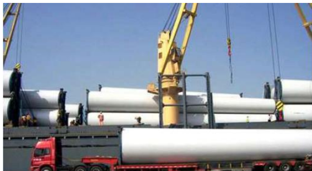
图 23：风电塔筒分段式运输
