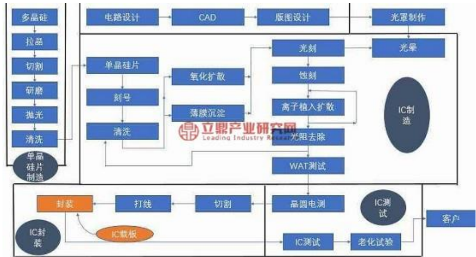
图 1：IC 封装产业工艺流程
