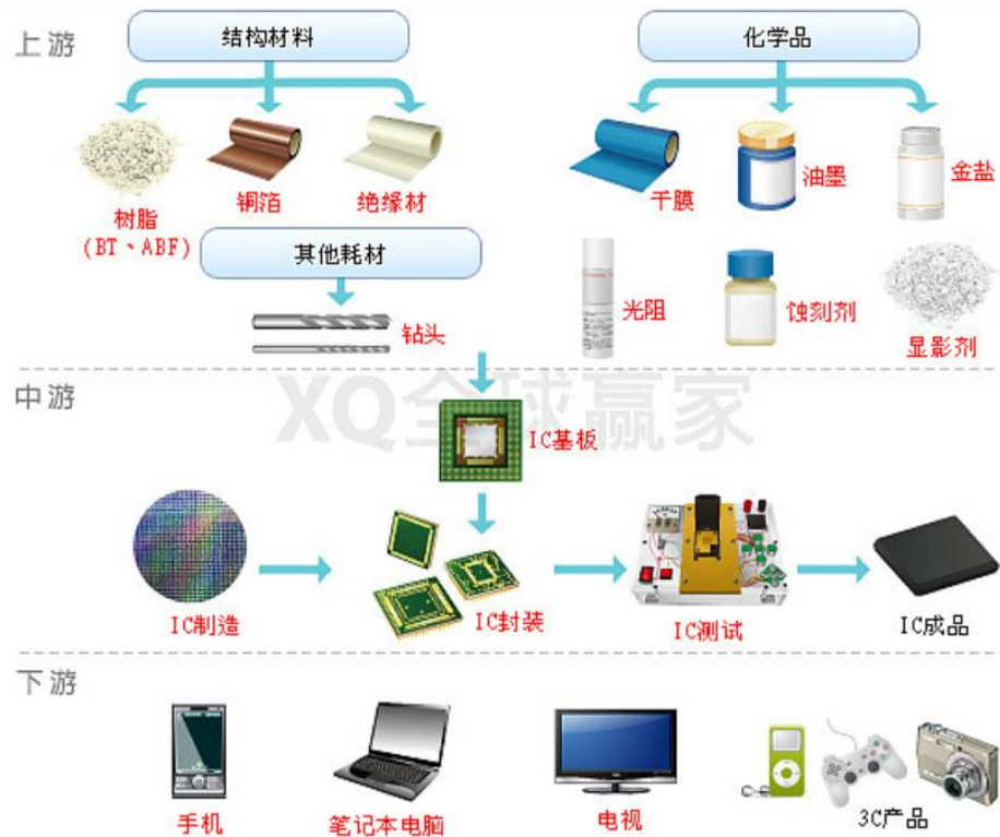
图 4：IC 载板产业链结构
