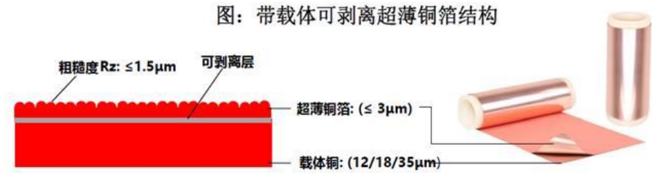
图 22：带载体可剥离超薄铜箔结构
